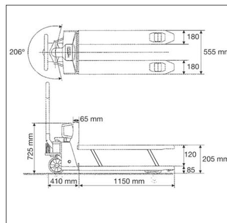
Transpallet dotato di protezione contro polvere e spruzzi d'acqua IP65/67 e memoria per un peso contenitore
